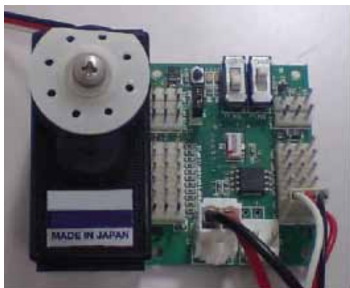
Slika 56. Motor za kontrolu pokreta stolice
